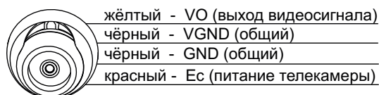
Рисунок 4 - Цвет и назначение проводов телекамеры AP-14SG
