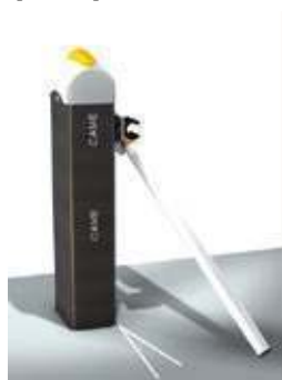
G028011 Система защиты стрелы от удара автомобиля, движущегося со стороны охраняемой территории. После соударения с автомобилем стрела выходит из крепления и поворачивается.
