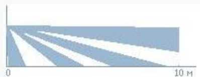
Схема зоны обнаружения в вертикальной плоскости Икар-5А
