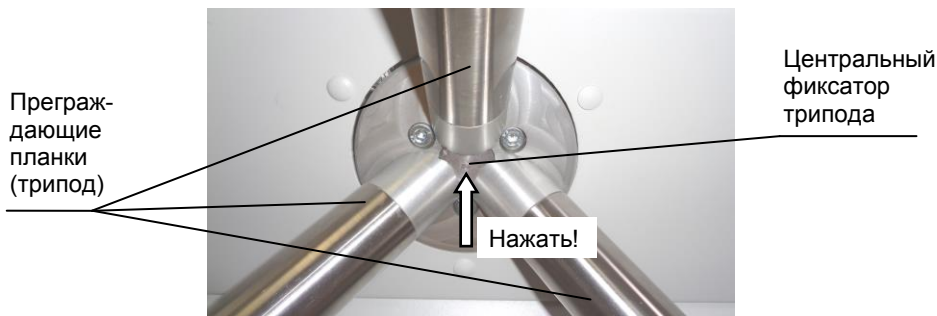
Рис.3 Место расположения центрального фиксатора трипода
