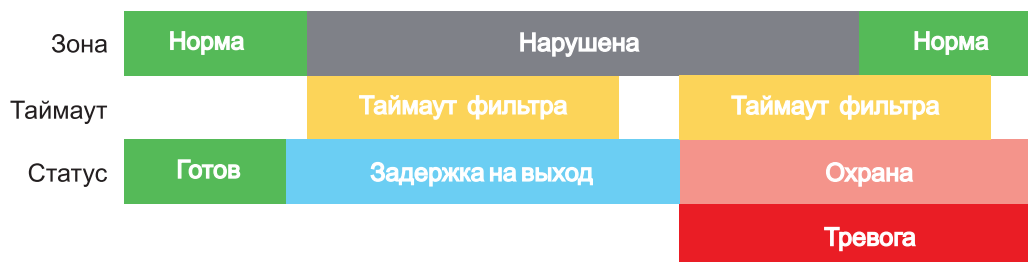
Рисунок 12. Нарушение зоны в момент постановки на охрану.
