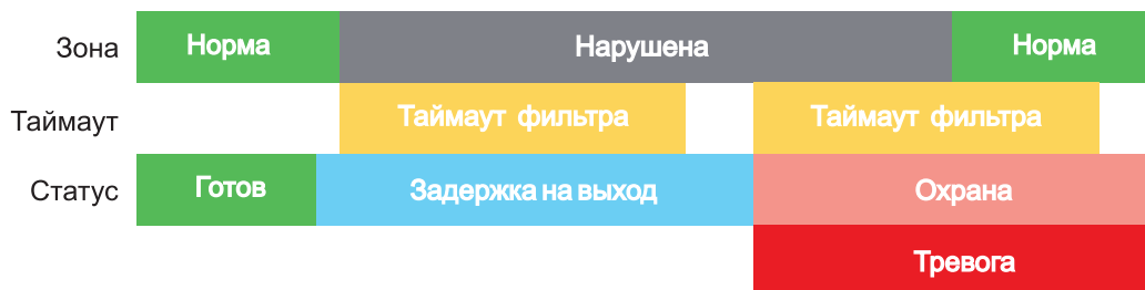
Рисунок 15. Нарушение зоны в момент постановки на охрану.
