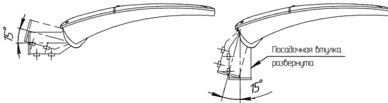
Рисунок 1.3 – Углы наклона светильника
