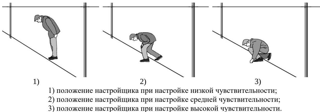
Рисунок 2.11 – Способы имитаций преодоления ЗО при приземном варианте установки.
