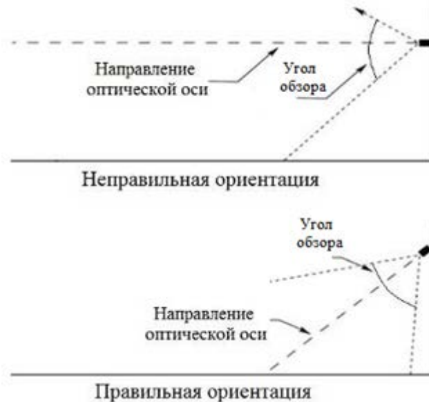
Рисунок 3 – Установка извещателя по отношению к горизонту
