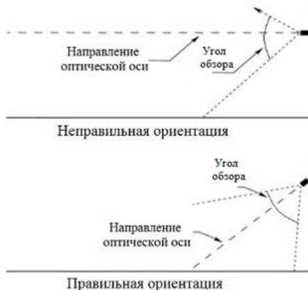
Рисунок 4 – Установка извещателя по отношению к горизонту
