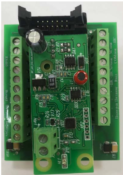
Рисунок 5 – Клеммная плата извещателя
