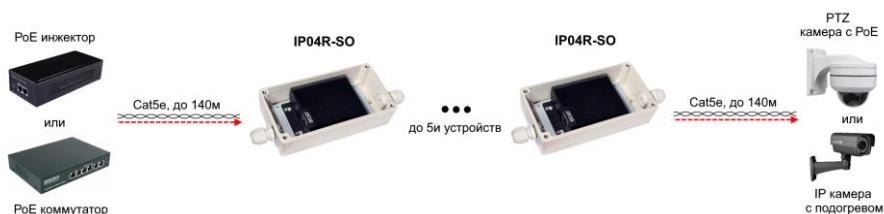
Рис.5 Каскадная схема подключения удлинителя IP04R-SO.
