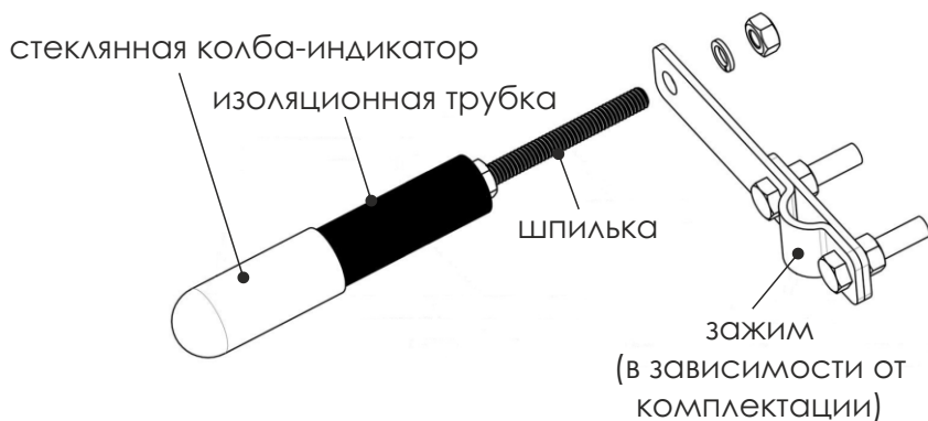
Рис. 6 Схема установки разрядника совместно с: а) штыревой изоляцией
