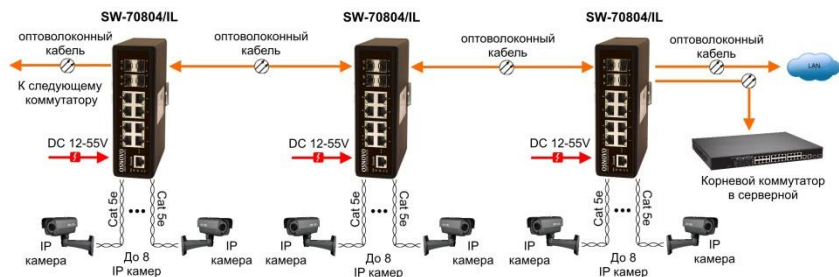
Рис.6 Типовая схема подключения коммутатора на примере SW-70804/IL
