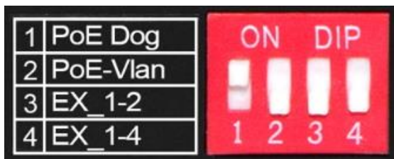
Рис.4 DIP-переключатель режимов работы коммутатора SW-70500-I
