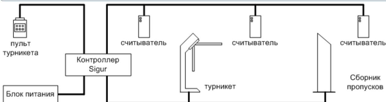
Рис. 37. Пример подключения турникета с картоприёмником.
