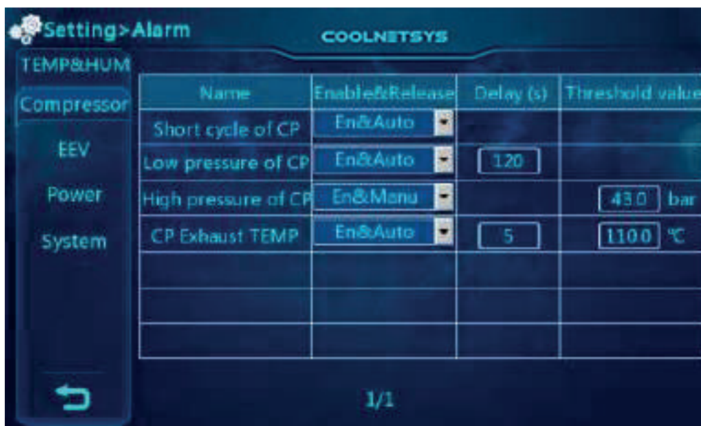
Рисунок 4-13 «Экран настройки аварийной сигнализации компрессора».
