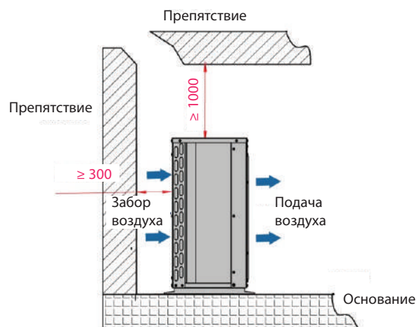
Рисунок 2-13 «Свободное пространство в случае установки рядом с препятствиями».
