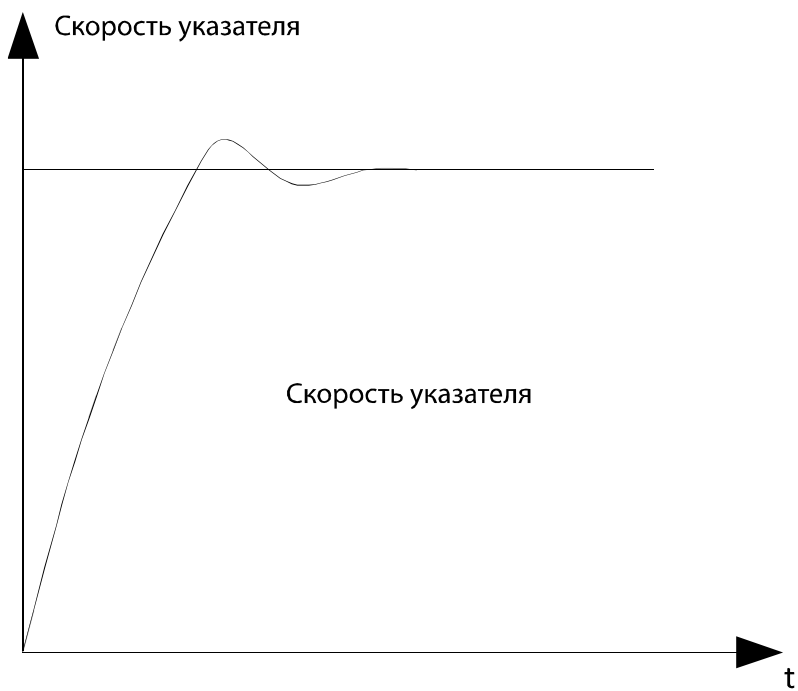
Кривая переходного процесса с хорошими динамическими характеристиками
