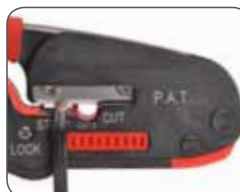
Зачистка плоского провода
