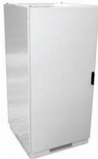
Батарейный кабинет BC1800 (885х875х1800), 5 полок 40 батарей 70-100 Ач
