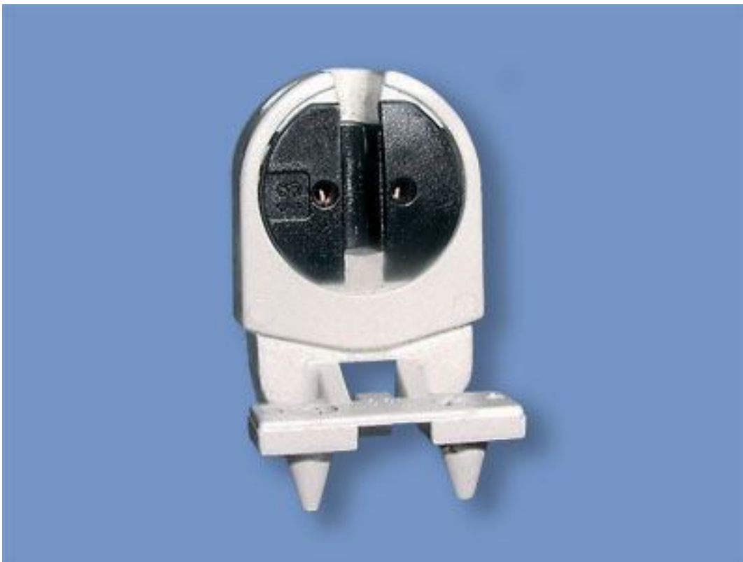
Патрон (ламподержатель) G5, вставной с лицевой стороны, h-оси 18mm, для люминесцентной лампы T5, (крепление на цапфы)
