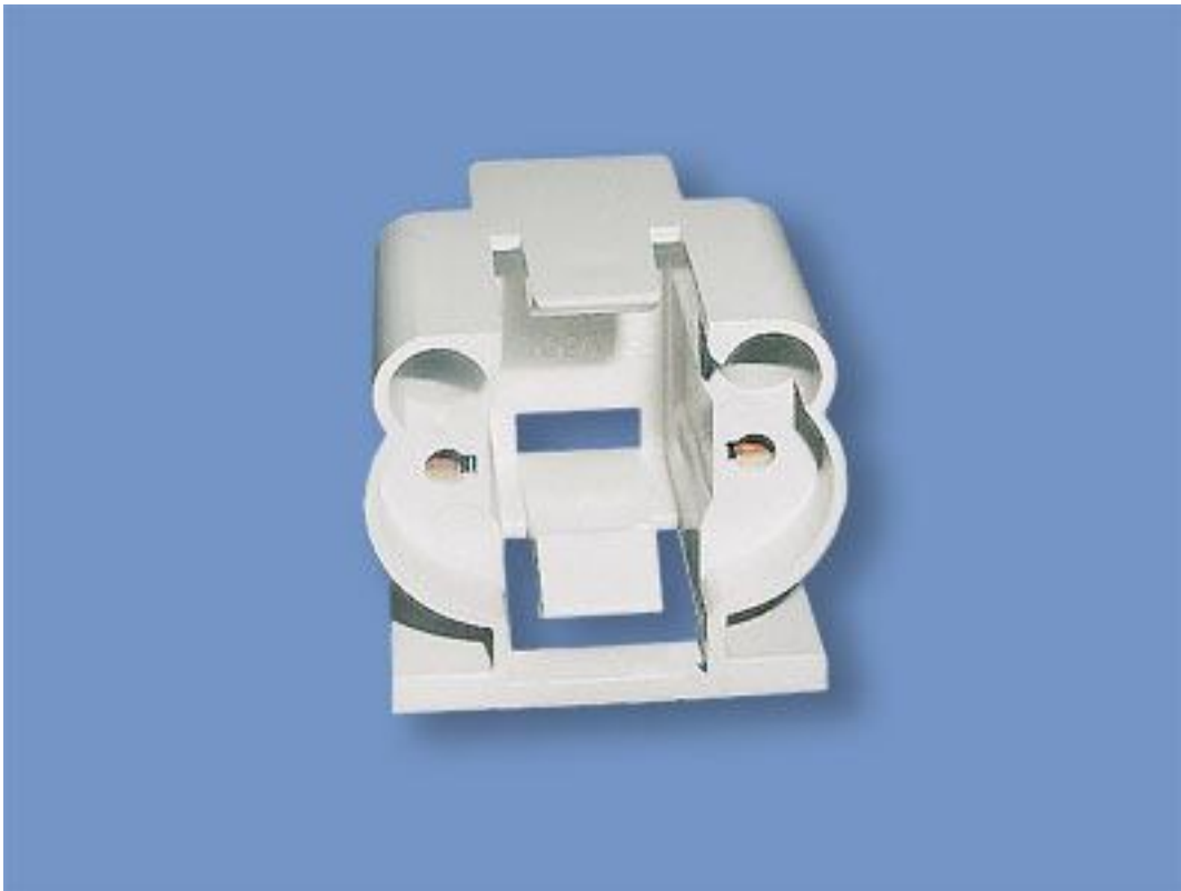
Патрон (ламподдержатель) G23 для компактных люминесцентных ламп (КЛЛ) типа TC-S, 2pin, накладной вывод проводов к тыльной стороне, крепление на винты (вертикально или горизонтально), РС
